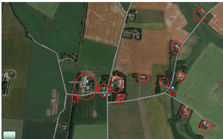
Figur 4: Landsby Borup, Borupvej og Bombækvej, 14 ejendomme, der bør anses for at være støjfølsomme områder. Dvs., at der højst må være 39 dB(A) ved en vindhastighed på 8 m/s og 37 dB(A) ved en vindhastighed på 6 m/s.
